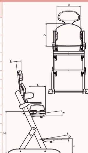
\* Longueur segment jambier max. = Hauteur du siège max - Hauteur du repose-pied min. (H)
