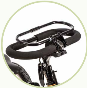
Guidon circulaire avec poignée de frein
