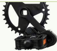
Raccourcisseurs de manivelle réglables en continu
