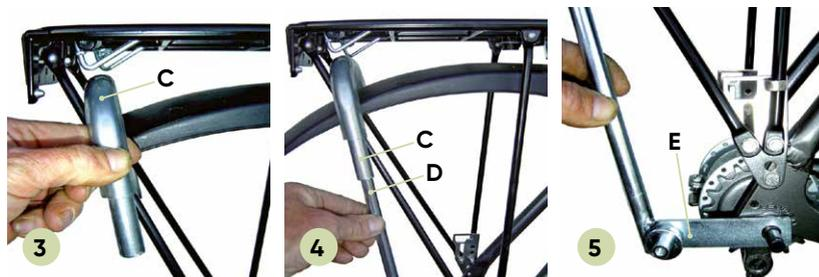
Fixez maintenant le tube en U (C) au porte bagage (F) à l'aide d'un collier de serrage (G). Effectuez ensuite les étapes 2 à 6 sur le côté gauche également. Enfin, replacer le boîtier (A).
