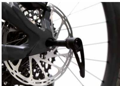
Prenez maintenant l'adaptateur (B), desserrez la vis (C) et insérez le (B) dans l'ouverture du cadre
