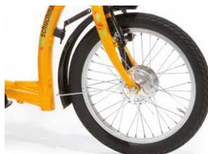
**L'effet de freinage peut diminuer en cas d'utilisation fréquente, veillez donc à réajuster régulièrement le câble Bowden des freins si vous remarquez une diminution de la force de freinage (voir point 3.2.1)**
