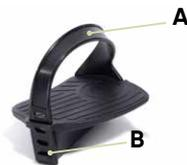
réglable en longueur et offre en même temps un léger guidage latéral. Pour régler la longueur de la sangle (A), tirez sur l'extrémité inférieure pour détacher la sangle (A) de l'obturateur (B). Réglez la sangle (A) à la longueur souhaitée.
