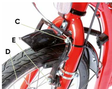
entre la jante et le patin ne doit pas dépasser 1,5 mm. À cet effet, desserrez la vis de serrage (C), pressez les sabots de freins ensemble à la main, tendez fortement le câble Bowden, puis resserrez fermement la vis de serrage. Si les sabots de freins ne sont pas exactement alignés sur le bord de la jante (D), corrigez le réglage. Pour modifier l'alignement des sabots des freins, desserrez les vis (E). En cas de doute, demandez à votre revendeur de procéder à cette opération.
