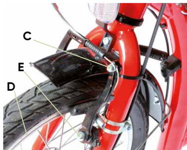
L'écart entre la jante et le patin ne doit pas dépasser 1,5 mm. À cet effet, desserrez la vis de serrage (C), pressez les sabots de freins ensemble d'une seule main, tendez fortement le câble Bowden, puis resserrez fermement la vis de serrage. Si les sabots de freins ne sont pas exactement alignés sur le bord de la jante (D), corrigez le réglage. Pour modifier l'alignement des sabots des freins, desserrez les vis (E). En cas de doute, demandez à votre revendeur de procéder à cette opération.
